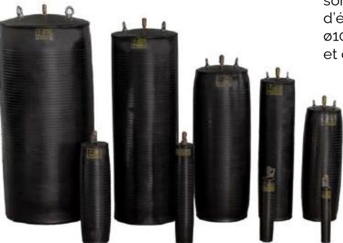
Ces obturateurs sont fabriqués avec un caoutchouc spécial renforcé par plusieurs couches de tissu Kevlar. Ces produits de test sont principalement employés pour l'étanchéité des réseaux d'égouts. De nombreux formats sont disponibles, allant du  $\varnothing 100$  au  $\varnothing 1000\text{mm}$ . Tous les obturateurs sont équipés de raccords rapides et d'embouts de connexion en matériaux résistants à la corrosion.
