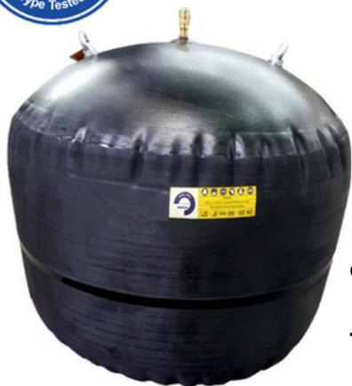
Les obturateurs gonflables pliable, sont spécialement conçu pour se plier pour pouvoir passer dans certains ouvrages difficiles d'accès. Vous pouvez ainsi passer d'un diamètre minime dégonflé au diamètre de la canalisation (ou autre) voulu. Ces obturateurs sont fabriqués avec un caoutchouc spécial renforcé par un tissu Kevlar. Il est possible de produire ces obturateurs dans d'autres dimensions à la demande pour des besoins spécifiques.
