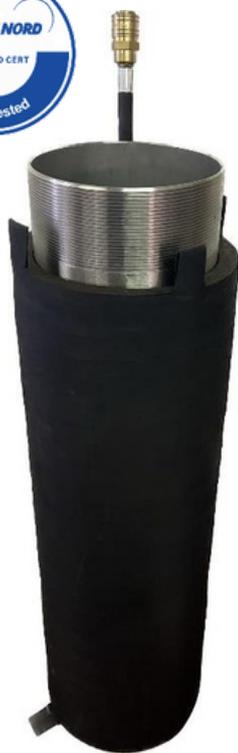
Ces obturateurs gonflables sont fabriqués en caoutchouc renforcé et ont l'avantage de permettre un passage GRAND débit. Le caoutchouc recouvre le passage en acier inoxydable. La gamme standard peut être fabriquée dans des dimensions allant du ø100 à ø1200mm. Il est possible de produire ces obturateurs dans d'autres dimensions à la demande pour des besoins spécifiques. Tous les obturateurs sont équipés de raccords rapides et d'embouts de connexion en matériaux résistants à la corrosion.
