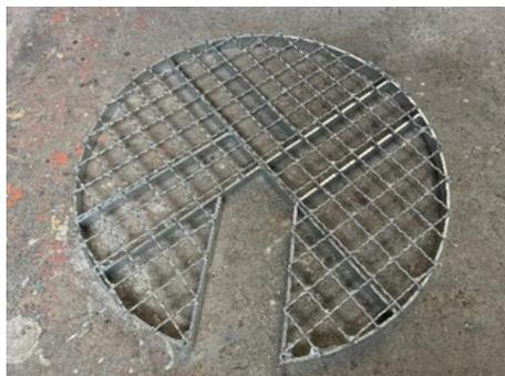
Les grilles de sécurité permettent la protection de regard circulaire contre les risques de chute. Conçu en acier ajouré et d'un passage de libre articulé (en option), elles sont idéales pour la sécurisation pendant les travaux de ventilations, de curage ou d'inspection TV.
