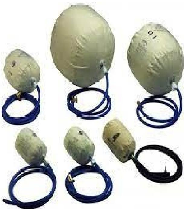
Les obturateurs gonflables PVC permettent de réaliser d'obturer des réseaux de tuyauterie ou gaine de ventilations. Ils sont employés pour des épreuves d'étanchéités, des travaux de maintenance et cela afin d'éviter des retours de produits dangereux. De nombreux formats sont disponibles, allant du  $\varnothing 50$  au  $\varnothing 300$ mm. Tous les obturateurs sont équipés d'un flexible d'une longueur d'un mètre et d'une valve auto pour le gonflage.
