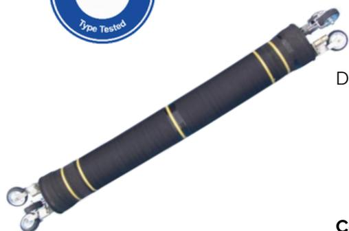
Les packers à passage sont flexibles et fabriqués avec un caoutchouc spécial renforcé par un tissu Kevlar d'une couche de textile en surface. Ils disposent de 3 roues à chaque extrémités et positionnées chacune à 120° pour faciliter le déplacement du packer dans la conduite.
