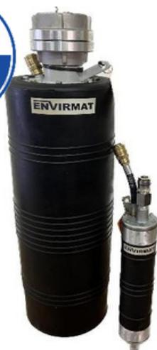
Ces obturateurs sont fabriqués avec un caoutchouc spécial renforcé par un tissu Kevlar. Ces produits de test sont principalement employés pour l'étanchéité des réseaux d'égouts. Ils sont utilisés pour les systèmes de test à l'air et à l'eau et sont équipés d'un passage. De nombreux formats sont disponibles, allant du ø35 au ø2800mm. Tous les obturateurs sont équipés de raccords rapides et d'embouts de connexion en matériaux résistants à la corrosion.
